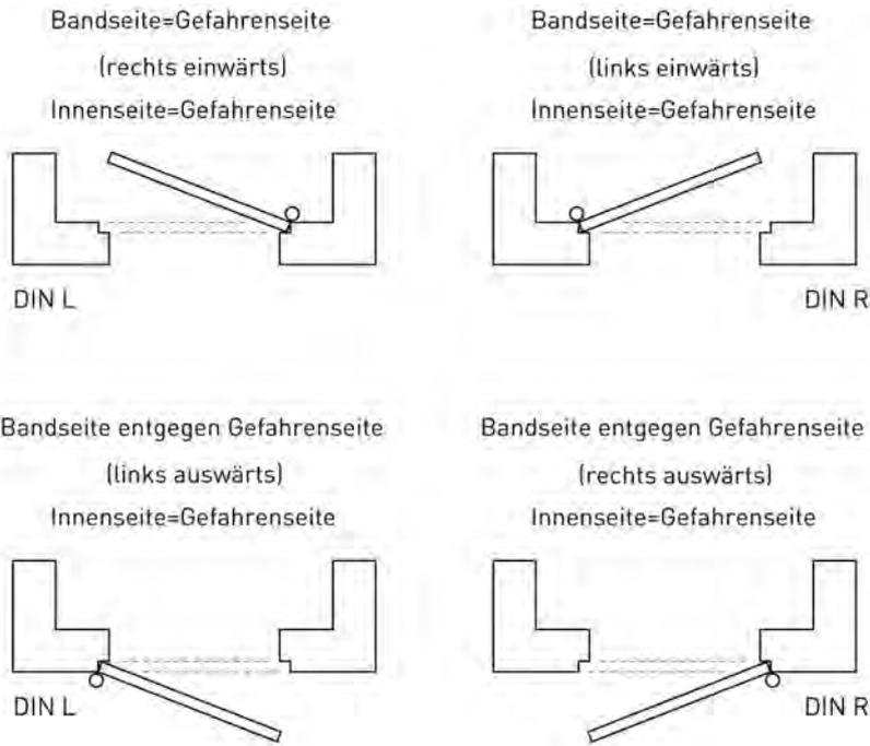
Von der Türbandseite aus wird die DIN-Bezeichnung für das Schloss bestimmt.
