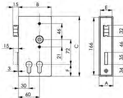
**AMF 140D, Schlosskasten komplett, für 30 und 40 mm Rohr, Entfernung 72 mm, Dornmaß 30/60 mm, Nuss 8 mm, 1-tourig, mit Wechsel, rechts und links verwendbar**
