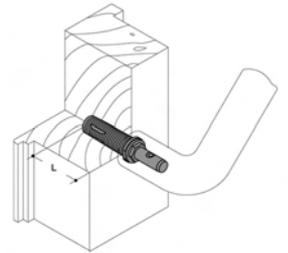
**E5011 und E5012, Stangengriff, gerade Form und schräge Form, Edelstahl, Achsmaß 300 mm, Griff Ø 30 mm, Länge 400 mm, inkl. Befestigungsset**
