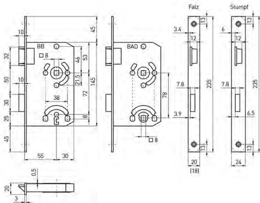
**Entfernung 72 mm, Dornmaß 55 mm, Nuss 8 mm, Falle und Riegel Zinkdruckguss, abgerundet**
