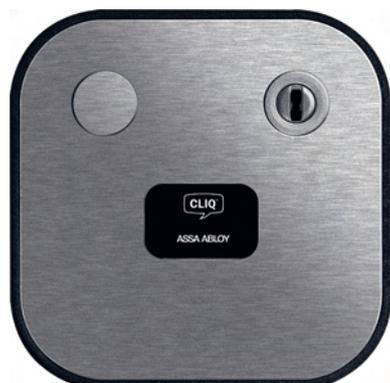
**Programmiergerät** als Mittlerfunktion bei der verschlüsselten Datenübertragung zwischen CLIQ Go App und dem Nutzerschlüssel. Die in der Software festgelegten Informationen werden über das Programmiergerät in den elektronischen Nutzerschlüssel geladen.
