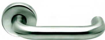
**FH-Rosettengarnituren, rund, für Feuerschutztüren, mit Stahlkerndrückern, Rosetten Ø 55 mm, Stärke 8 mm, Nuss 9 mm, Türstärke 44–66 mm, mit Vierkantstift**
