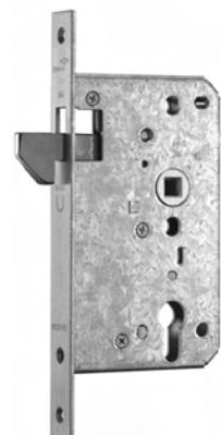
Schiebetürschloss mit Hakenfalle, Entfernung 72 mm, Dornmaß 55–70 mm, Stulp 24 x 235 mm, Nuss 9 mm, Falle verschließbar, verzinkt, mit Schließblech
