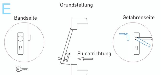
\* Eine Öffnung von der Gefahrenseite ist in allen Funktionen immer möglich. Schlösser nach DIN EN 170 mit Umschaltfunktion sind sowohl in Fluchrichtung (auswärts), als auch gegen die Fluchrichtung (Gefahrenseite gleich Bandseite) öffnend erhältlich. **Die Öffnungsrichtung muss bei der Schlossbestellung angegeben werden.**
