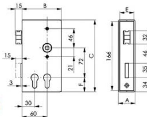
**AMF 140D, Schlosskasten komplett, für 30 und 40 mm Rohr, Entfernung 72 mm, Dornmaß 30/60 mm, Nuss 8 mm, 1-tourig, mit Wechsel**
