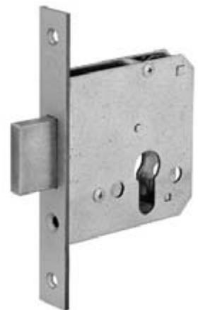
**BEVER 286 Einsteck-Riegelschloss Stulp 20 x 160 mm, 2-tourig, rechts und links verwendbar, Riegel aus Zinkdruckguss mit 23 mm Riegelausschluss, silberfarbig**
