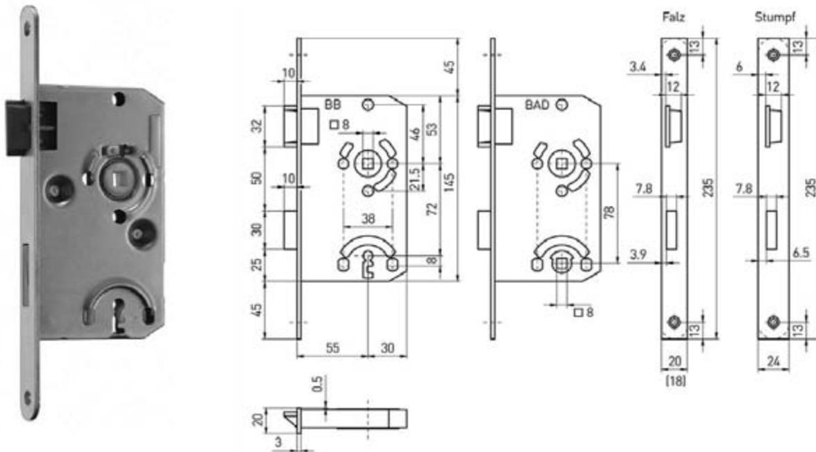
**Entfernung 72 mm, Dornmaß 55 mm, Nuss 8 mm, Falle und Riegel Zinkdruckguss**
