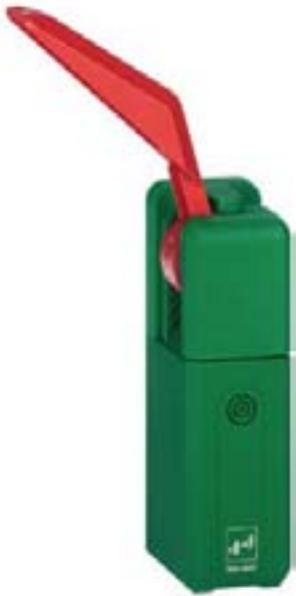
Alarm bei missbräuchlicher Benutzung eines Notausgangs: eine Betätigung des Türdrückers wird akustisch und optisch angezeigt. Durch seine Positionierung bildet der EXITalarm 7411 eine visuelle Hemmschwelle gegen unbefugtes Benutzen der Tür. Mit einer 9 V-Batterie als Spannungsversorgung ist es das ideale Produkt für eine Nachrüstung ohne die sonst notwendige Verkabelung.
