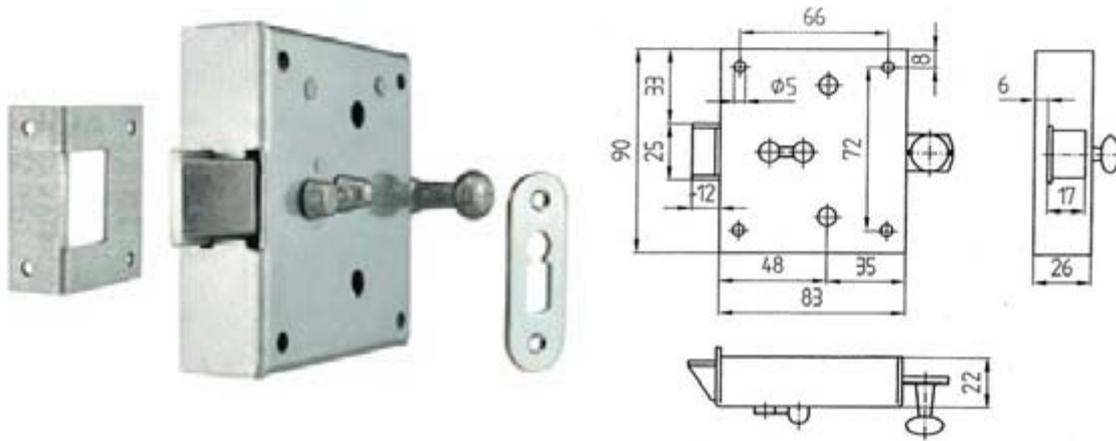
**BEVER 932U Knopfriegelschloss (Kabussenschloss), 2-tourig, rechts und links verwendbar, auf „einwärts“ umstellbar, mit Schließblech und Schlüsselschild, mit 2 Schlüssel**
