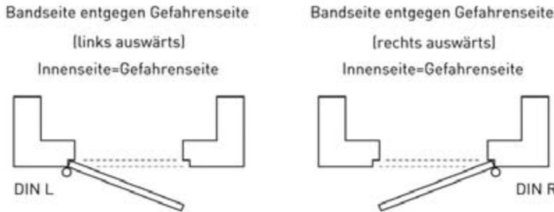
Von der Türbandseite aus wird die DIN-Bezeichnung für das Schloss bestimmt.
