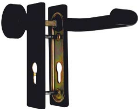
Kurzschildgarnituren Kunststoff schwarz mit Stahlkern und Stahl-Schildeinlage, Türstärke 40–63 mm, Entfernung 72 mm, Nuss 9 mm
